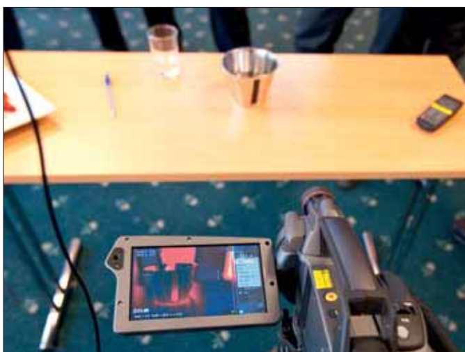
Lars Michelgård visar hur man kan termografera en vätska. Han rör om i vattnet och värmebilden visar hur de olika temperaturerna blandas. Skillnader under 0,1 grader kan observeras.
